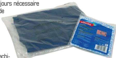
Sans rétraction, les machines sont utilisées avec des films Polyéthylène de faible épaisseur; de 30 à 60 microns. Ces films assurent principalement une protection des produits, comme par exemple pour des produits textiles en blanchisserie.
