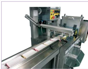
Dans la plupart des cas, ces machines utilisent des films Polypropylène d'épaisseur variant entre 30 et 80 microns ou des films complexes thermosoudables ou soudables à froid. Il est possible d'utiliser du film Polyéthylène uniquement sur les machines à barre de soudure accompagnante en version spéciale.
