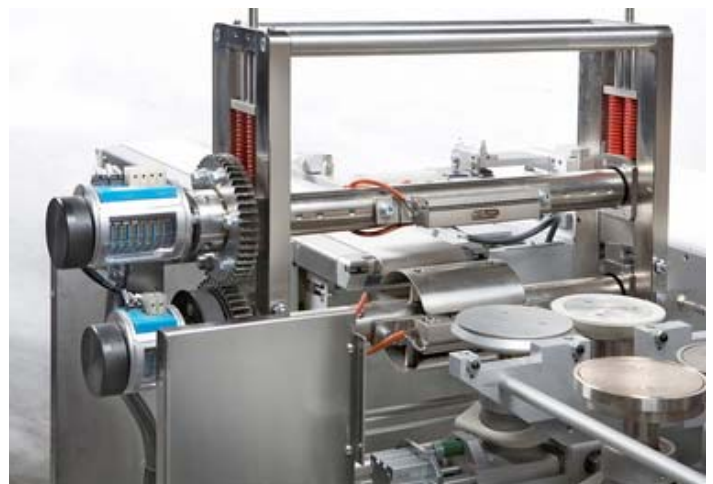
Mâchoires rotative avec perforation européenne dans sa soudure
