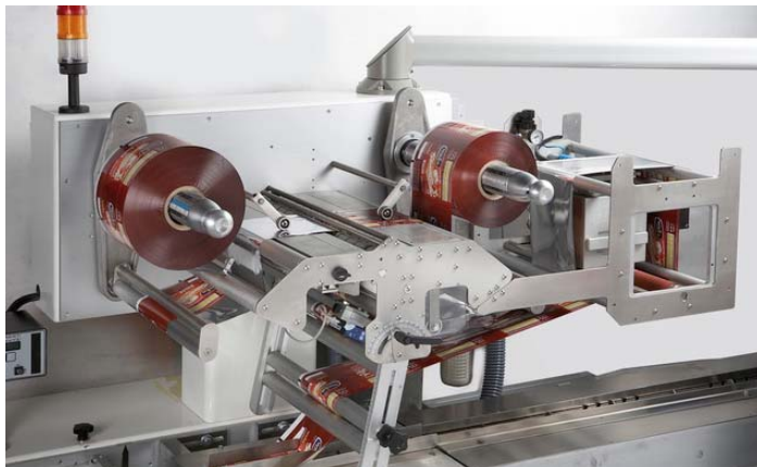
Double porte bobine à jonction automatique avec système de marquage .
