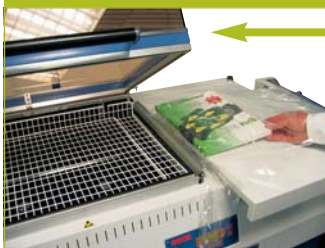
DEMPACK H 18 cadre de soudure de 300 x 440 mm. Le modèle H22 SE est un modèle économique sans refroidissement liquide, ni support à roulette.
