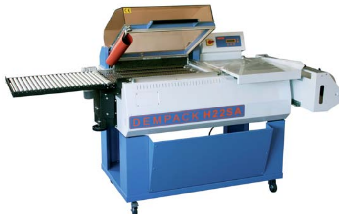
DEMPACK H 22SA cadre de soudure de 430 x 560 mm Evacuation automatique des produits.
